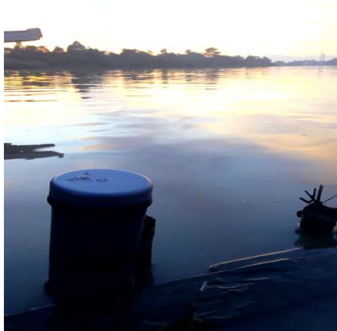
Gambar 8. Prototip node sensor pada pengujian pertama di sungai Jeneberang
