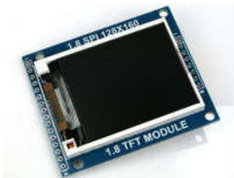
Gambar 4.9. ST7735 1.8" TFT LCD (Sumber : www.google.com )
