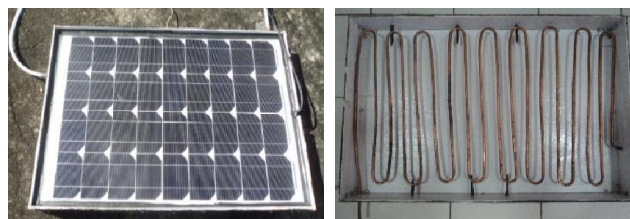
Gambar 4. Modul Fotovoltaik dan Konstruksi pipa tembaga di dalam kotak ekstraksi
